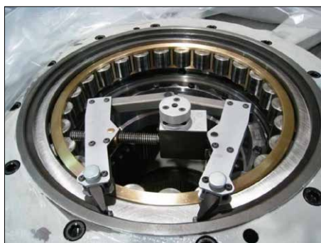
jedno narzędzie do dużych pierścieni osadycznych wewnętrznych i zewnętrznych
