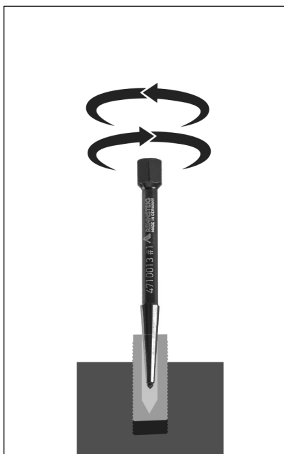
poluzuj i wykręć zaklinowaną śrubę za pomocą odpowiedniego narzędzia
